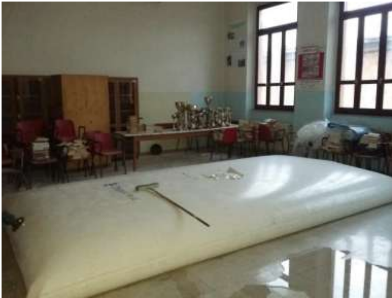
Prova di carico
